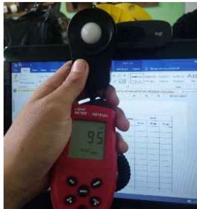
Gambar 5. Pengukuran Intensitas Cahaya Pada Kondisi Lampu Ruang Mati
