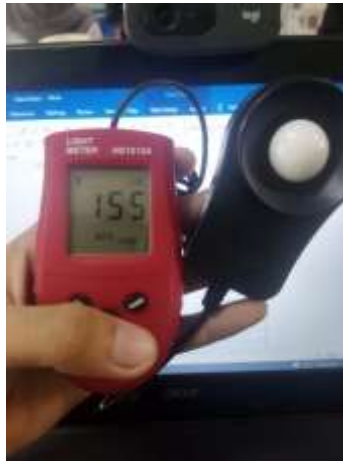
Gambar 6. Pengukuran Intensitas Cahaya Pada Kondisi Lampu Ruangan Hidup
